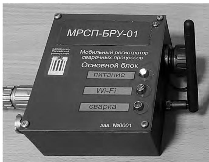
Рис. 1. Внешний вид основного блока мобильного регистратора
