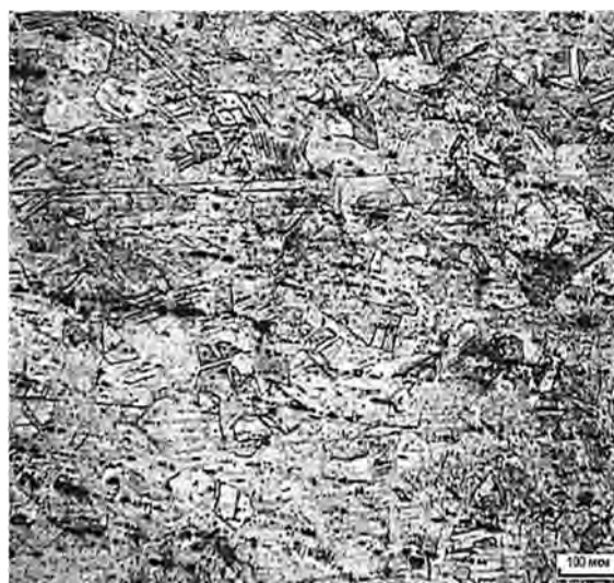
Рис. 2. Микроструктура образцов до и после волочения (×50)
