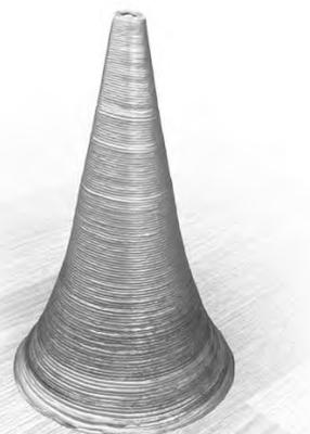
Рис. 1. Внешний корпус элемента, полученного аддитивной наплавкой
