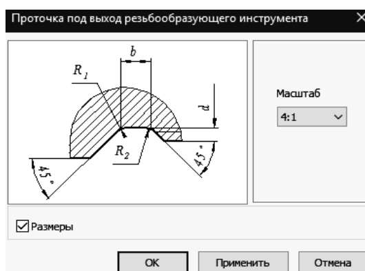
Рисунок 11.29 – Проточка под выход резьбообразующего инструмента
