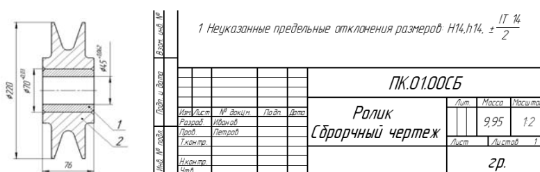
Рисунок 15.2 – Оформление сборочного чертежа
