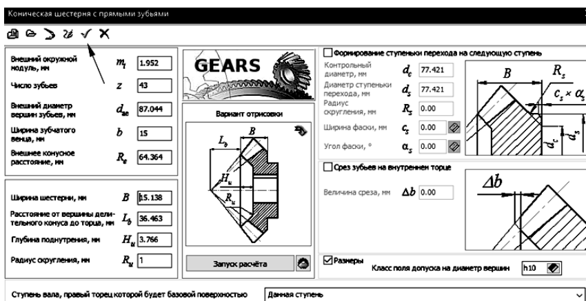
Рисунок 11.6 – Параметры для построения конической шестерни с прямыми зубьями
