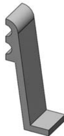
Рисунок 8.2 – Результат применения команды Вытянутая бобышка
