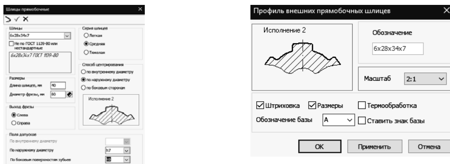
Рисунок 11.30 – Параметры для построения прямоугольных шлиц и создания выносного элемента
