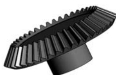
Рисунок 11.9 – Результат генерации конической шестерни с прямыми зубьями
