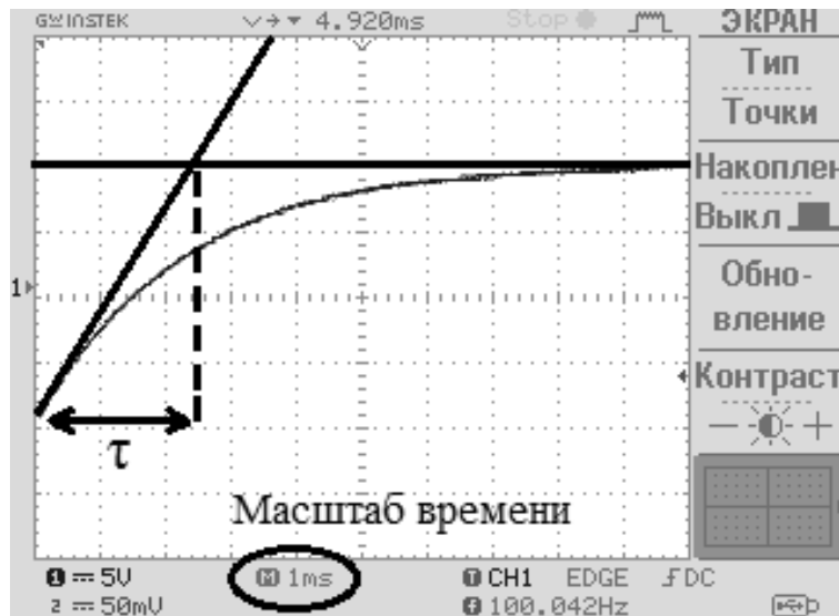
Рисунок 5.2 – Способ определения постоянной времени цепи по осциллограмме
