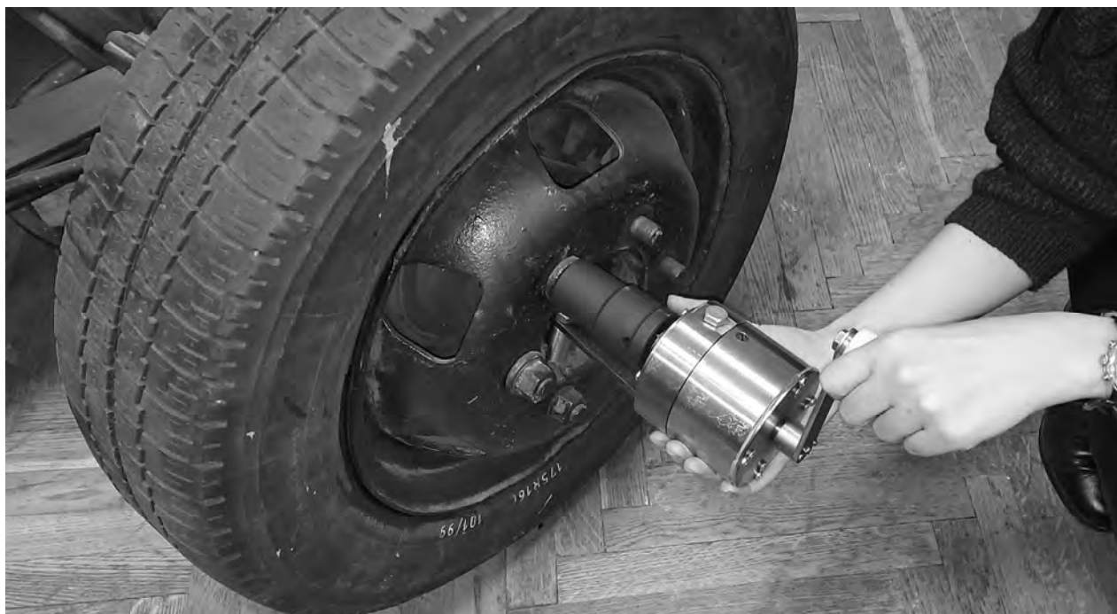
Рисунок 4.31 – Установка баллонного ключа на колесе автомобиля ГАЗ-3302
