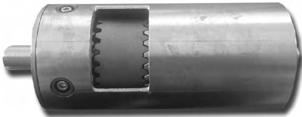
Рисунок 1.19 – Редукторная вставка для насоса с двухвенцовым сателлитом
