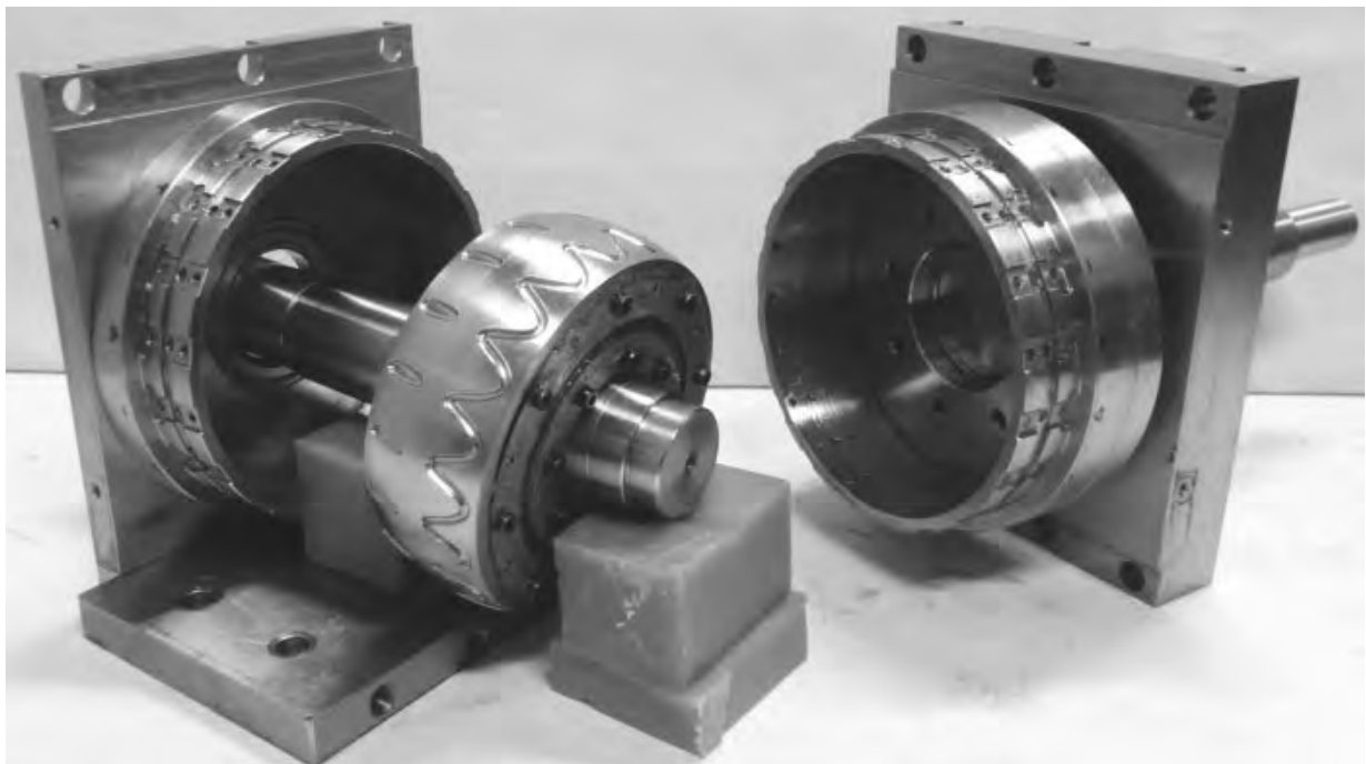
Рисунок 1.23 – Сферическая двухконтактная шариковая передача с сателлитом, взаимодействующим с двумя рядами тел качения
