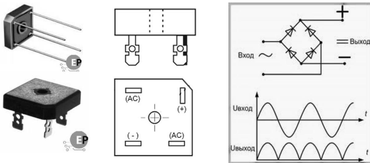
Рисунок 3.2 – Выпрямительный диодный мост GBPC3508W
