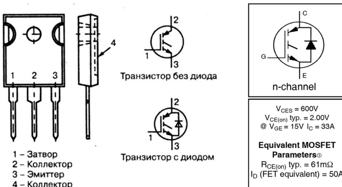
Рисунок 4.2 – Расположение выводов и характеристики IGBT-транзистора типа IRGP50B60PD1 в корпусе TO-247AC: G – Gate (Затвор); C – Collector; E – Emitter
