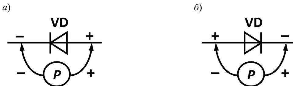
*а* – при прямой полярности; *б* – при обратной полярности
