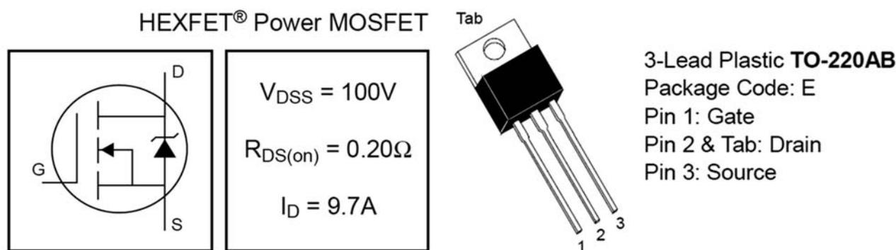
Рисунок 4.3 – Расположение выводов и характеристики MOSFET-транзистора типа IRF520N n-канального в корпусе TO-220AB
