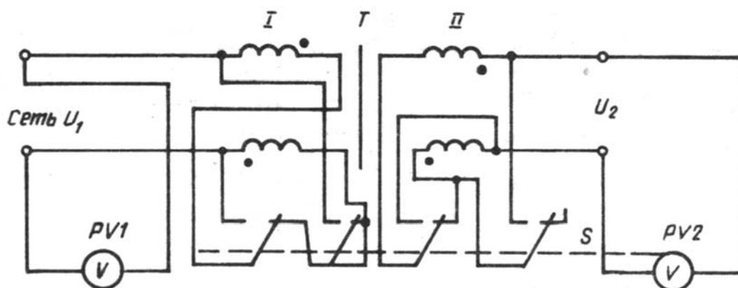
Рисунок 2.2 – Схема измерения коэффициента трансформации
