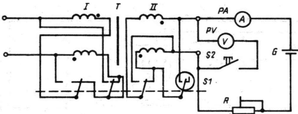
$T$  – трансформатор;  $I$  и  $II$  – первичная и вторичная обмотки;  $S1$  – переключатель;  $S2$  – кнопка;  $R$  – подстроечный резистор;  $G$  – источник тока
