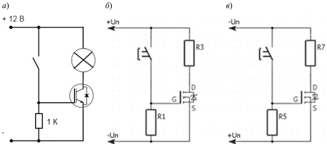
Рисунок 4.4 – Схема проверки силовых IGBT транзисторов (а),  $n$ -канального (б) и  $p$ -канального (в) MOSFET-транзисторов
