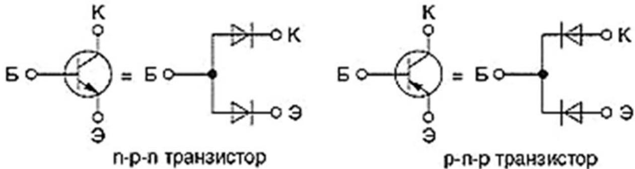
Рисунок 4.1 – Проверка исправности биполярных транзисторов
