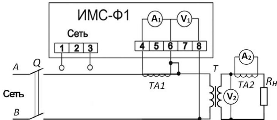
Рисунок 2.3 – Схема установки для испытания сварочного трансформатора
