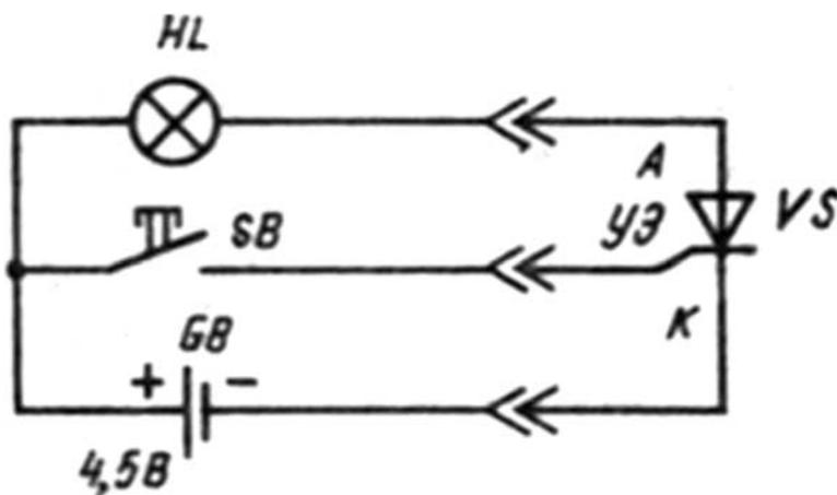
Рисунок 3.3 – Проверка работоспособности тиристоров
