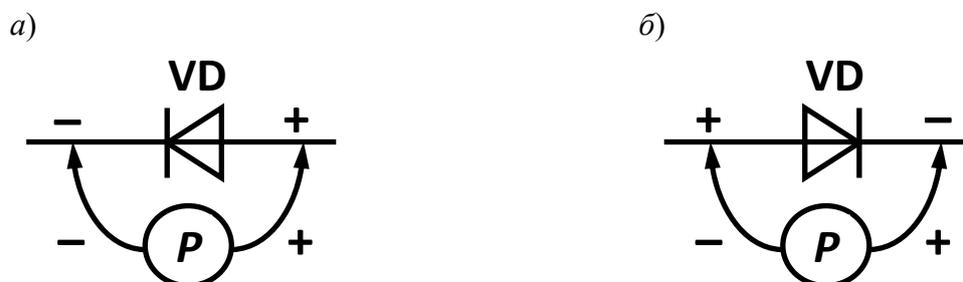
Рисунок 3.1 – Проверка диодов при прямой (*а*) и обратной (*б*) полярностях
