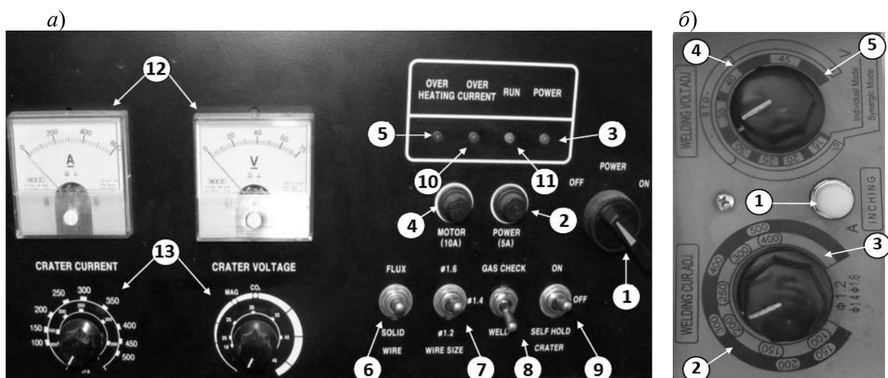
а – источник питания; б – подающее устройство
