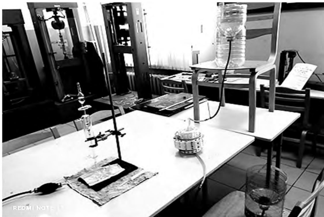
Рис. 1. Схема установки магнитной активации топлива
