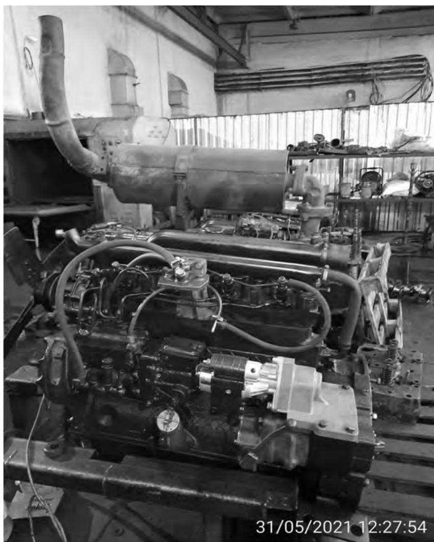
Рис. 3. Стендовые испытания магнитного активатора топлива
