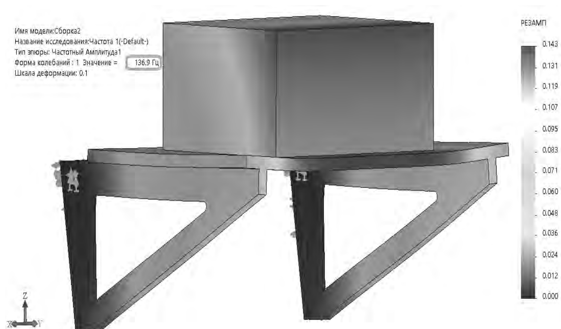
Рис. 6. Первая собственная частота и форма колебаний консольной опоры электродвигателя
