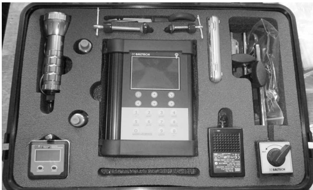
Рисунок 2.3 – Схема оборудования для уравнивания ротора
