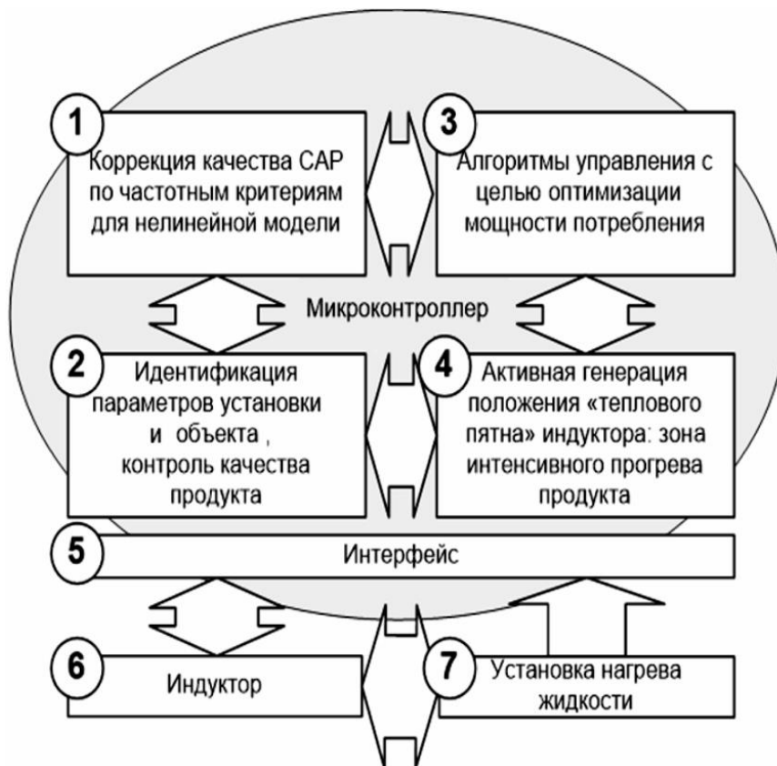
Рисунок 1– Общая структура программно-аппаратного обеспечения системы косвенного индукционного нагрева жидкости как объекта с параметрическими неопределенностями
