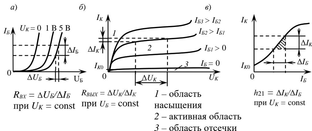
Рисунок 27 – Вольт-амперные характеристики биполярного транзистора при включении в режиме с общим эмиттером.
