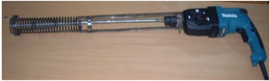
Рис. 15. Виброуплотнитель на базе электрического перфоратора
