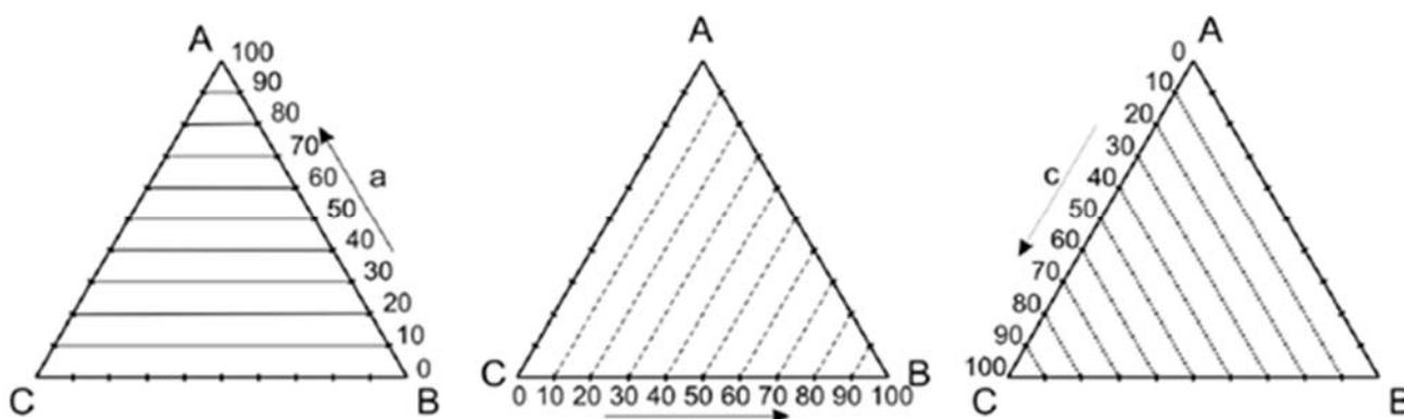
Рисунок 1.1 – Линии одинаковых концентраций для координат А, В и С
