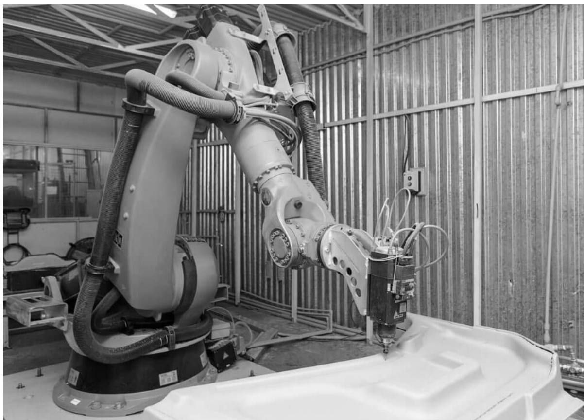
Рисунок 13.1 – Роботизированный участок фрезерования
