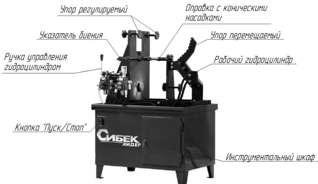
Рисунок 3.1 – Описание конструктивных элементов оборудования стенда для правки колесных дисков «Сибек Лидер»
