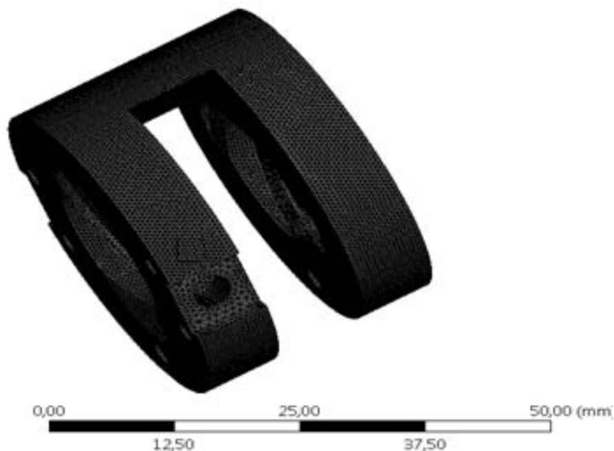
Рисунок 5.1 – Разбиение на одиннадцати поверхностях (применено разбиение поверхностей с размером элемента 1 мм)
