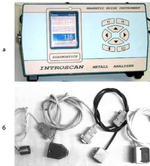
Рис.2. Магнитошумовой анализатор Introscan (а) и ПБ (б)
