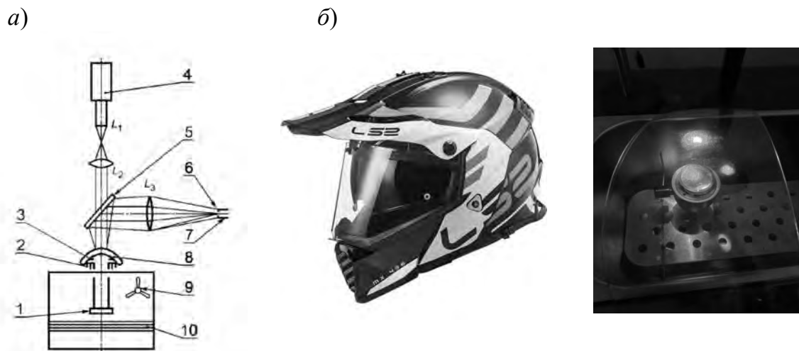
Рис. 1. Принципиальная схема установки (а) и контролируемый объект (б)
