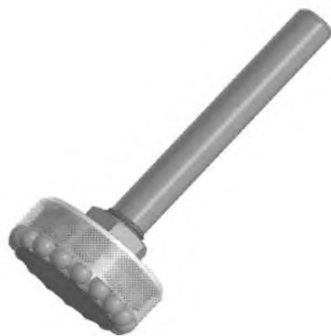
Рис. 1. Модель магнитно-динамического накатника для модифицирования валов
