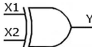
Рисунок 1.12 – Условное обозначение логического элемента ИСКЛЮЧАЮЩЕЕ ИЛИ (XOR)
