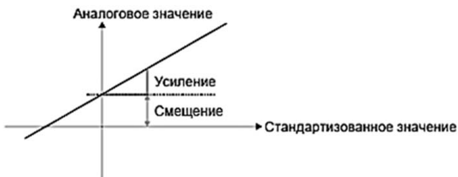
Рисунок 4.2 – Порядок преобразования аналогового сигнала в контроллере LOGO
