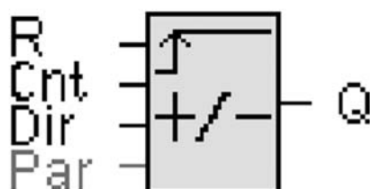
Рисунок 7.1 – Схематическое изображение реверсивного счетчика
