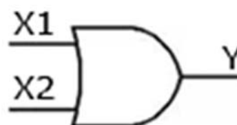
Рисунок 1.4 – Условное обозначение логического элемента ИЛИ (OR) за рубежом
