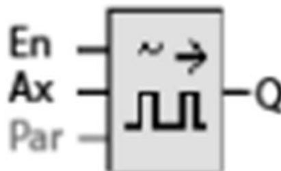
Рисунок 7.5 – Схема блока широтно-импульсного модулятора
