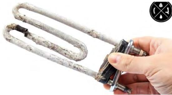
Рис. 2. Результат эксплуатации ТЭН-а в контуре нагрева ТЖ пастеризатора
