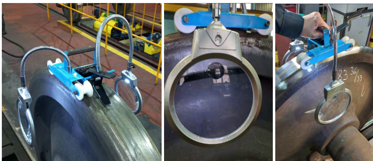
Рис. 1. Приспособление для визуального контроля цельнокатаного колеса (внедрено в Гомельском вагонном депо РУП «Гомельское отделение Белорусской железной дороги»)
