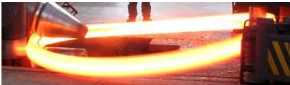
Рис. 1. Процесс кольцераскатки маложесткого кольца
