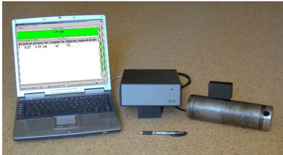
Рис.1 – Средства ультразвукового контроля глубины упрочняемых поверхностных слоев металлов термической и химико-термической обработкой
