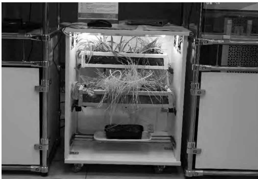
Рис. 4. Система вертикального озеленения на основе гидропоники
