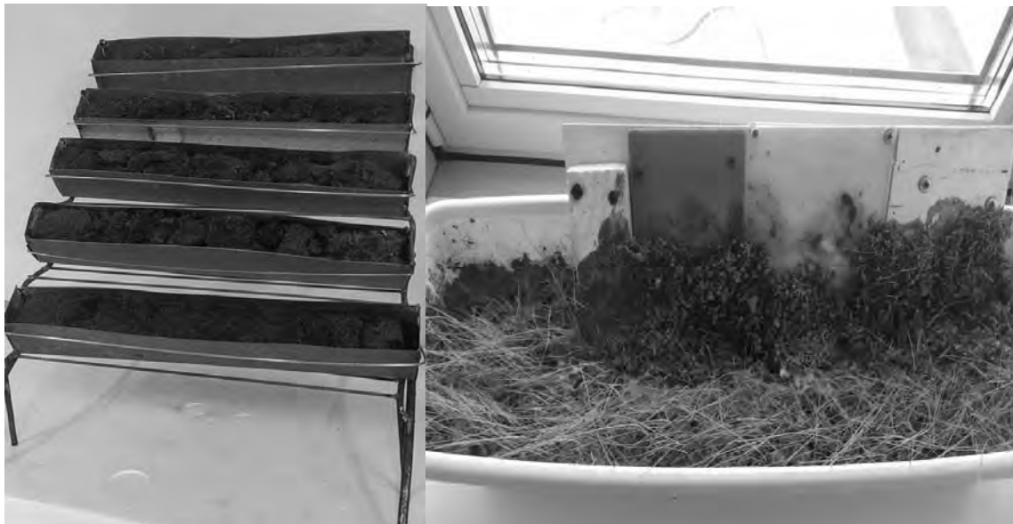
Рис. 2. Системы вертикального озеленения на основе заращивания мхами вертикальных поверхностей
