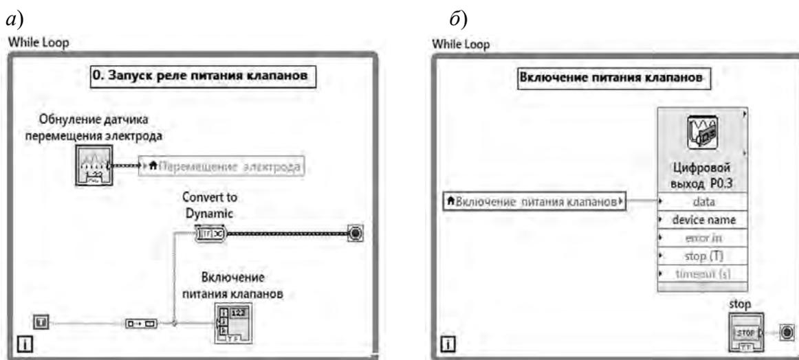
Рис. 1. Подключение питания клапанов и обнуление датчика перемещения
