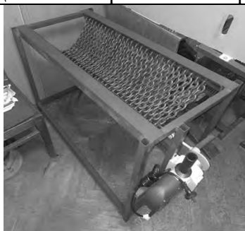
Волновой аппарат с возвратно-поступательным движением рабочей камеры
