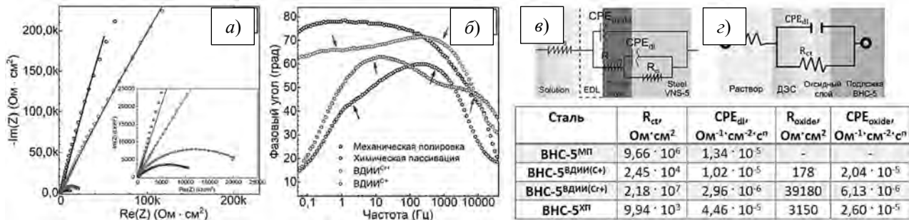
Рис. 1. Диаграммы импеданса в координатах Найквиста (а) и Боде (б) и эквивалентные электрические схемы (в, г) образцов стали ВНС-5, различающихся способом поверхностной обработки (на вставке – количественные данные аппроксимации ЭИС кривых)
