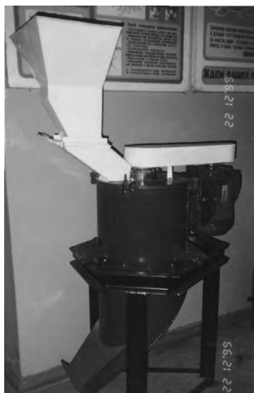
Рис. 1. Дробильная установка и схема конструкции дробилки: 1 – загрузка; 2 – ударные элементы; 3 – отражатель; 4 – вертикальный вал; 5 – выгрузочное окно; 6 – ременная передача; 7 – электродвигатель; 8 – корпус
