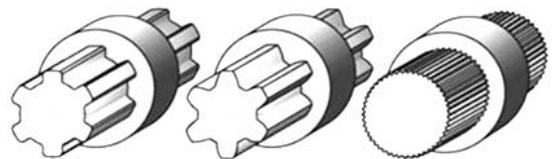
Рисунок 10.5 – Профиль зубьев шлицевого соединения
