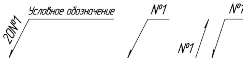
Рисунок 7.12 – Обозначение одинаковых сварных швов
