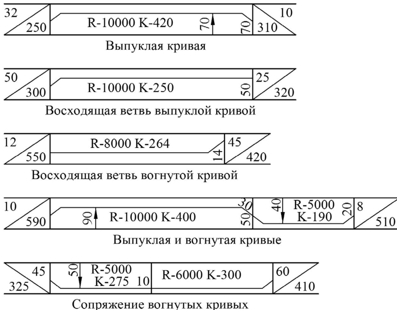
Рисунок 3.1 – Обозначение вертикальных кривых продольного профиля
