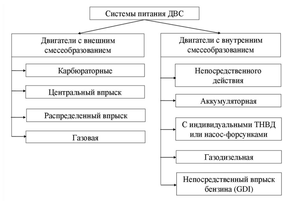
Рисунок 4.1 – Классификация систем питания ДВС
