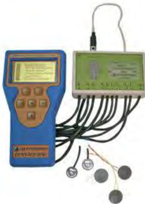
Рис. 1. Измеритель плотности теплового потока
