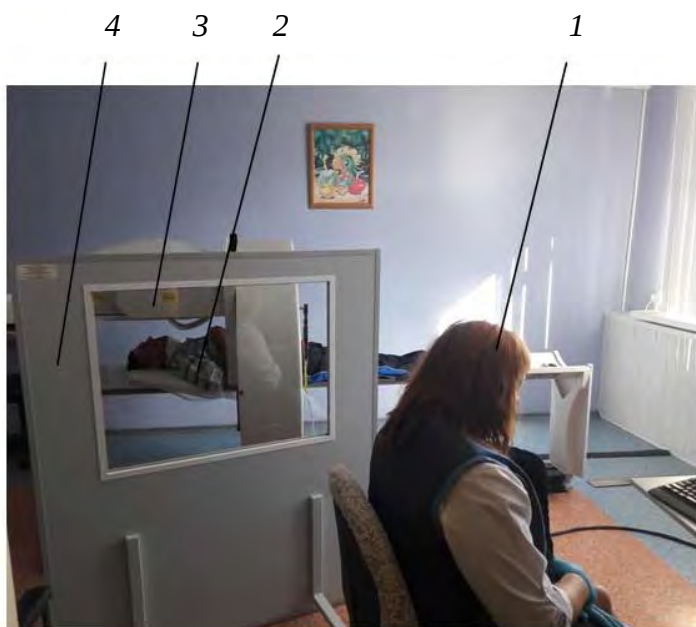
Рис. 4. Рабочее место медсестры изотопной лаборатории: а – с ширмой; б – без ширмы; 1 – медсестра; 2 – пациент; 3 – гамма-камера; 4 – защитная ширма с окном для наблюдения за состоянием пациента
