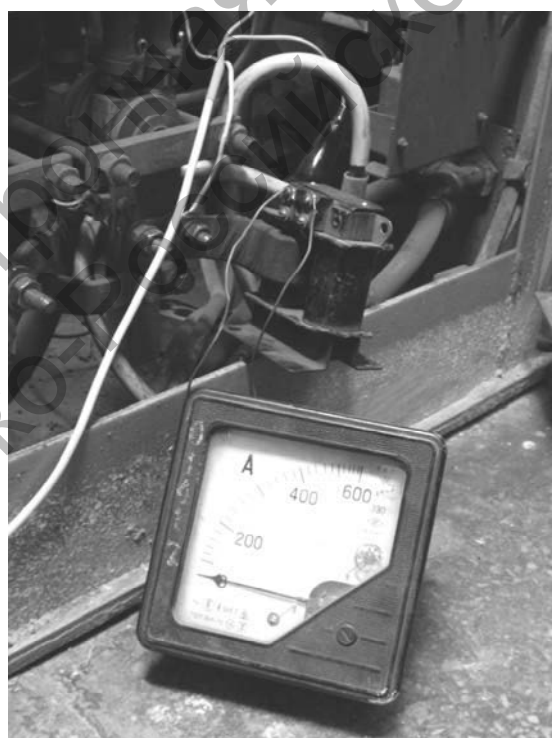
Рис. 4. Регистрация тока в первичной цепи машины МТ-3201
