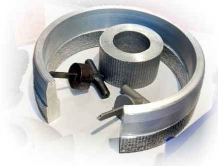
Рис. 1. Внешний вид аддитивных наплавов из Al-сплавов
