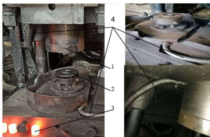
1 – пуансон; 2 – матрица; 3 – заготовка; 4 – система водоохлаждения
