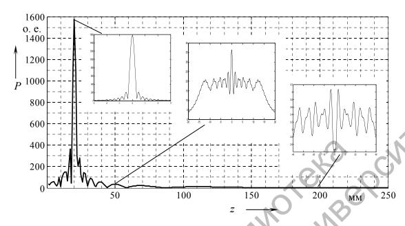
Рис. 3. Распределение давления акустической волны вдоль оси сферической пьезопластины диаметром 20 мм и с радиусом кривизны 20 мм
