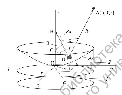
Рис. 6. Схема для расчета акустического поля фокусирующего преобразователя на основе плоской пьезопластины с плоско-вогнутой линзой: 1 – пьезопластина; 2 – плоско-вогнутая линза
