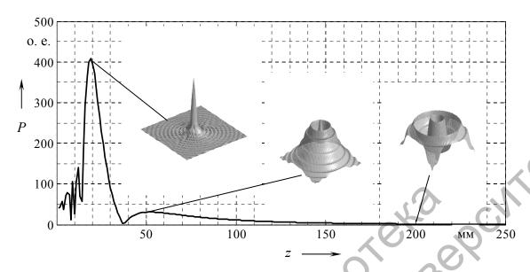
Рис. 2. Распределение давления акустической волны вдоль оси сферической пьезопластины диаметром 10 мм и с радиусом кривизны 20 мм
