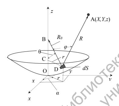
Рис. 1. Схема для расчета акустического поля сферического ПЭП
