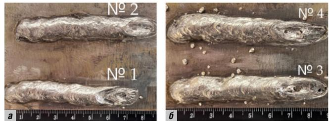
Рис. 17. Вид наплавленных валиков 1–4 опытными электродами с покрытием  $\text{TiO}_2\text{-CaF}_2\text{-CaO}$  со стержнем Св-10Х16Н25АМ6 диаметром 4 мм под водой. На поверхности имеются брызги металла
