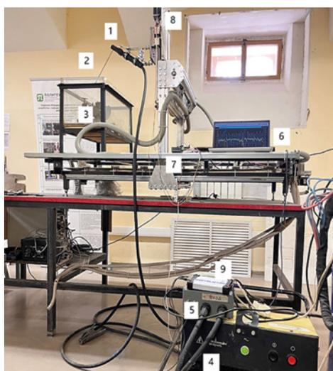
**Рис. 1.** Лабораторный стенд для подводной мокрой сварки: 1 — электродержатель; 2 — электрод; 3 — резервуар; 4 — выпрямитель; 5 — датчики тока и напряжения; 6 — компьютер; 7 — контроллер шагового двигателя; 8 — электропривод; 9 — USB-осциллограф
