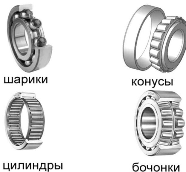
Рисунок 11.1 – Конструкции подшипников качения
