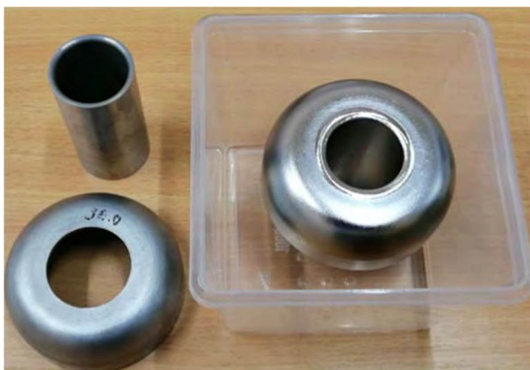
Рис. 5. Внешний вид деталей узла «чашка – трубка дрейфа» до (слева) и после сварки
