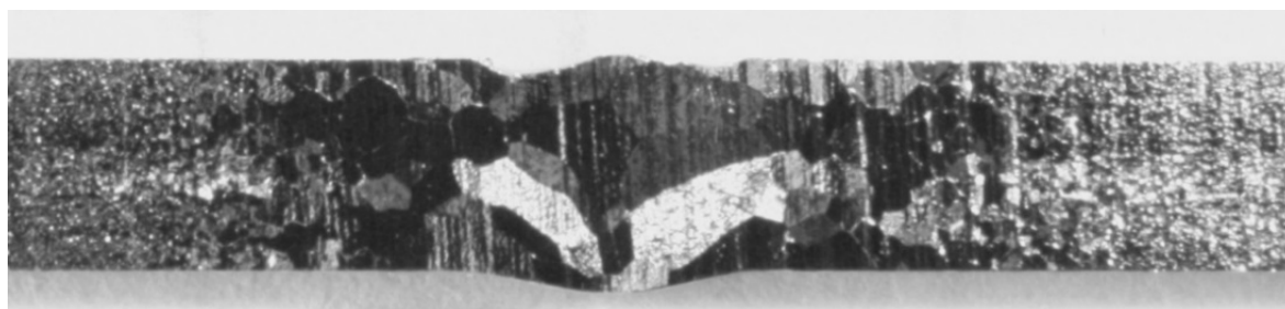
Рис. 1. Внешний вид сварного соединения на ниобии толщиной 3 мм ( \times 10 )
