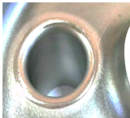
Рис. 8. Внешний вид узла «крышка с трубками» в сборочно-сварочной оснастке перед ЭЛС (а) и после сварки (б)
