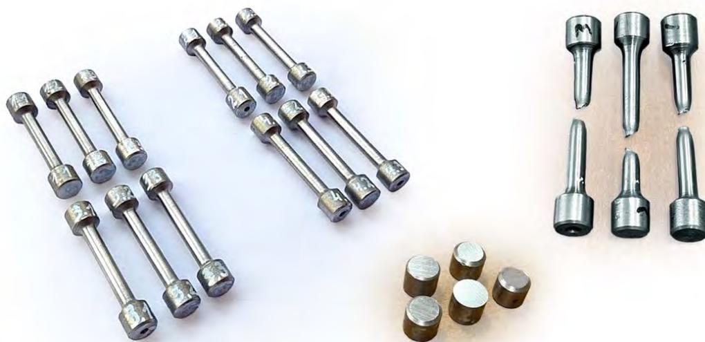
Рис. 1. Внешний вид образцов для определения свойств наплавленного металла при испытании на статическое растяжение и измерения твердости
