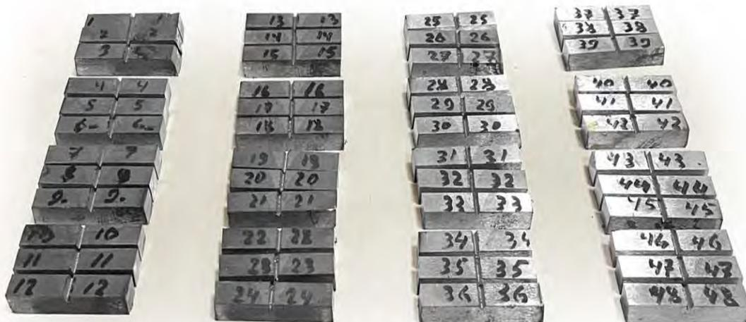
Рис. 3. Внешний вид образцов для проведения испытаний на ударный изгиб наплавленного металла
