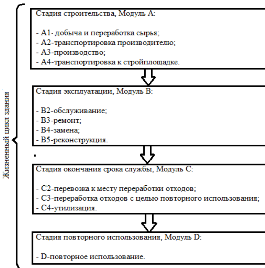
Рис. 2. Стадии жизненного цикла здания
