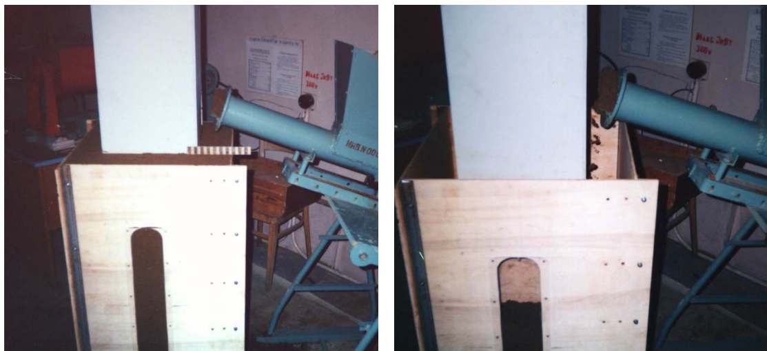
Рисунок 2 – Подача и укладка бетонной смеси шнековым питателем в конструкцию усиления
