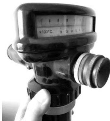
Рисунок 1.2 – Оптический пирометр с исчезающей нитью (а) и его принципиальная схема (б)
