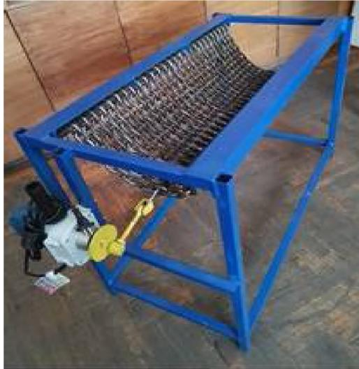
Рис. 2. Опытный образец волнового цепного грохота
