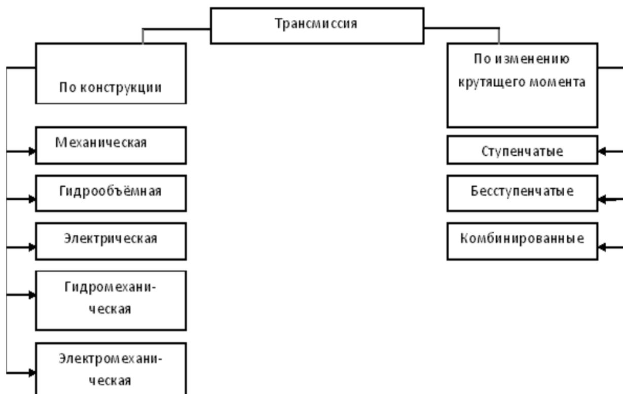
Рисунок 1.4 – Типы трансмиссий автомобилей
