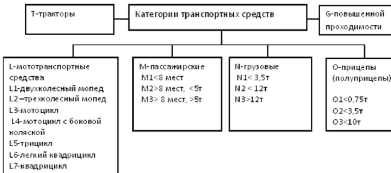
Рисунок 1.1 – Схема классификации дорожных транспортных средств по категориям
