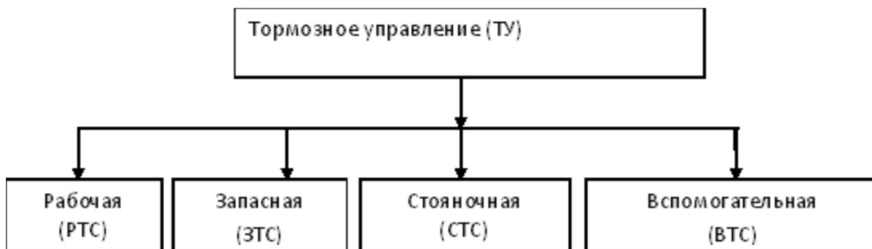
Рисунок 1.9 – Классификация тормозных систем
