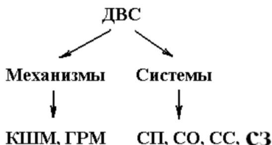
Рисунок 1.3 – Схема устройства поршневого ДВС
