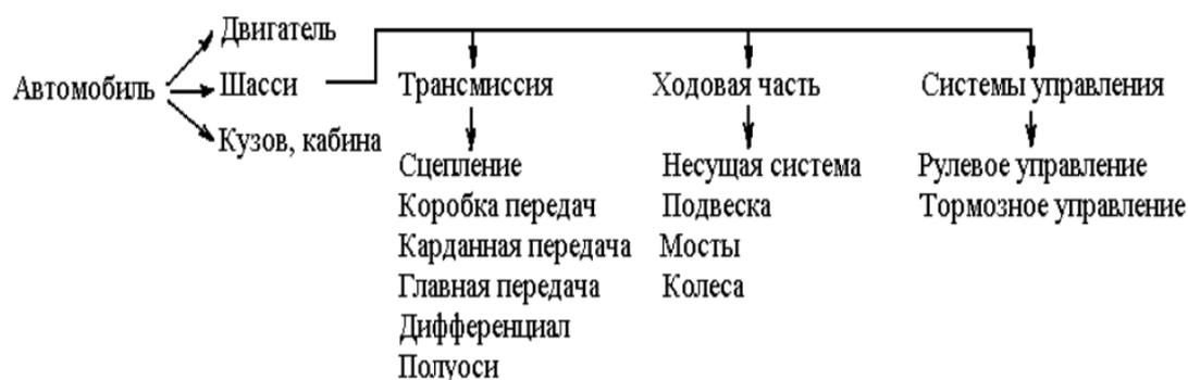
Рисунок 1.2 – Схема устройства автомобиля
