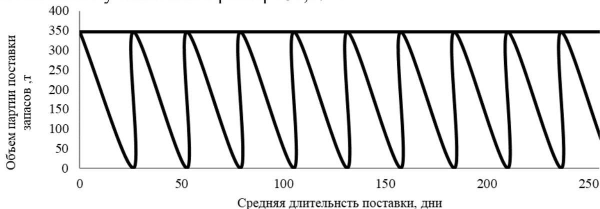
Рис. 1. График движения запасов нити полиэфирной в многономенклатурной модели EOQ независимых поставок от нескольких поставщиков по усредненному периоду поставки
